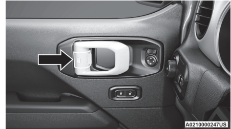
Manual Door Lock
